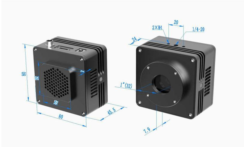
图 12-15 CTR3CMOS 整机尺寸(单位: mm)
